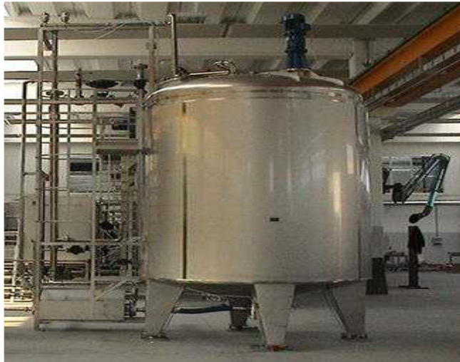
FIGURA 42.- FUENTE: TANQUE PULMON ISOTERMICO PARA NECTAR
