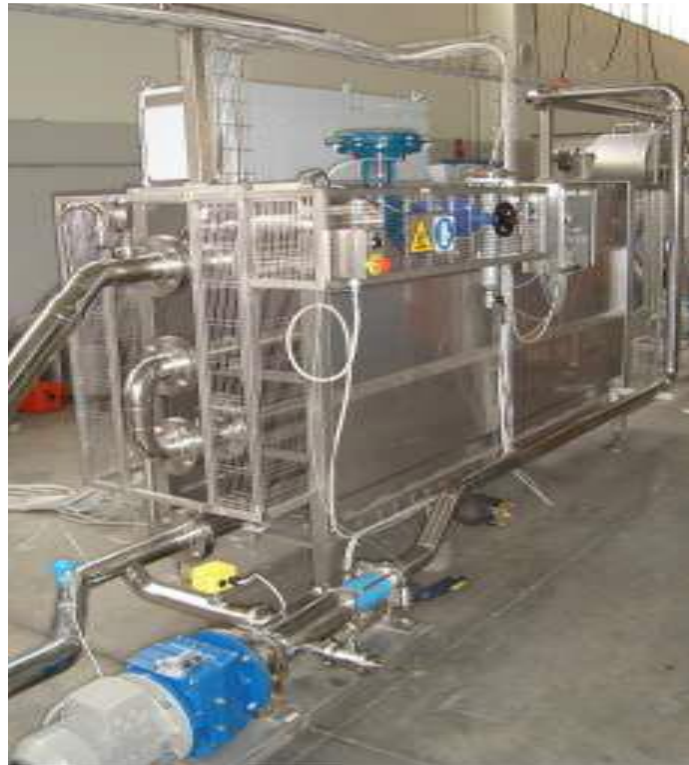
FIGURA 23.- FUENTE: WEB-ESTABILIZADOR ENZIMATICO TUBULAR CON ENFRIAMIENTO
