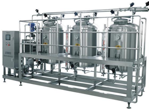
FIGURA 64.- FUENTE: WEB-CIP (CLEANING IN PLACE)
