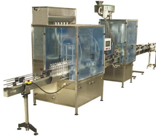
FIGURA 56.- FUENTE: LINEA DE EMBOTELLADORA PET (LAVADORA, ENVASADORA, TAPADORA, CODIFICADORA Y ETIQUETADORA).
