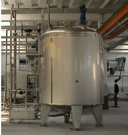
FIGURA 52.- FUENTE: TANQUE PULMON ISOTERMICO PARA NECTAR
