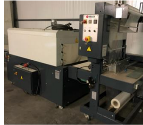
FIGURA 58.- FUENTE: TUNEL DE EMPACADO FILM TERMOCONTRAIBLE (RETRATILADORA)
