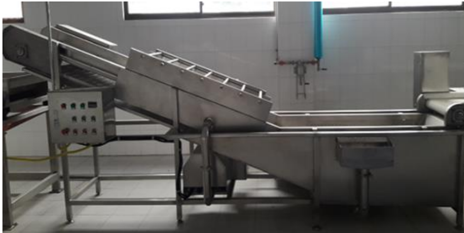
FIGURA 32.- FUENTE: WEB TINA DE LAVADO CON TRANSPORTADOR DE RODILLOS.
