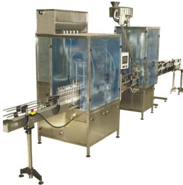
FIGURA 42.- FUENTE: LINEA DE EMBOTELLADORA PET (LAVADORA, ENVASAADORA, TAPADORA, CODIFICADORA Y ETIQUETADORA).
