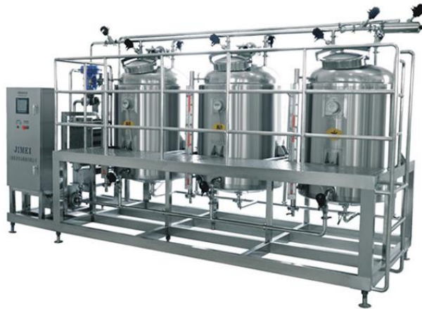
FIGURA 64.- FUENTE: WEB-CIP (CLEANING IN PLACE)
