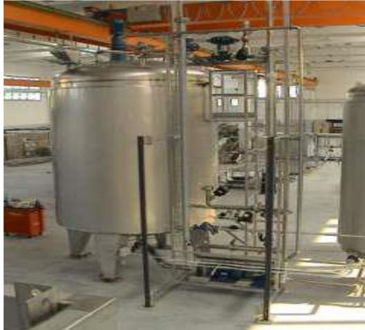
**FIGURA 30.- FUENTE: TANQUE DE MEZCLA CON AGITADOR VERTICAL SIROPE**
