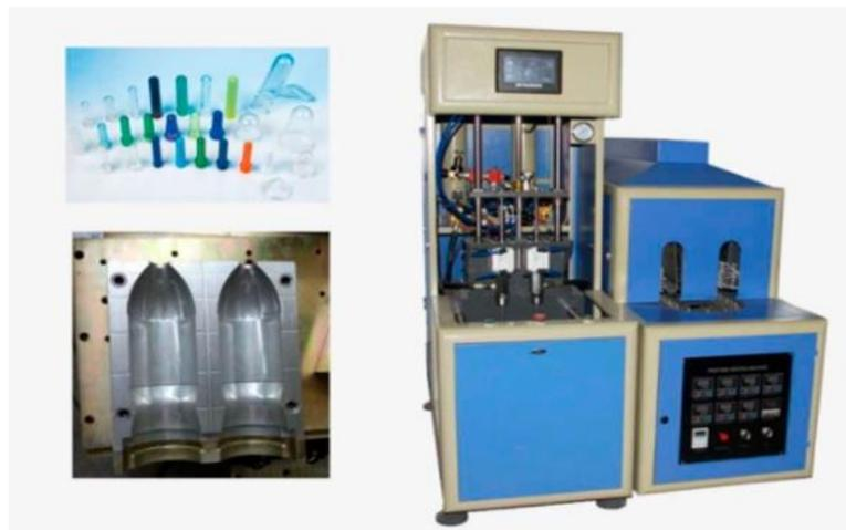
**FIGURA 61.- FUENTE: WEB-SOPLADORA DE BOTELLAS PET (MOVIL)**
