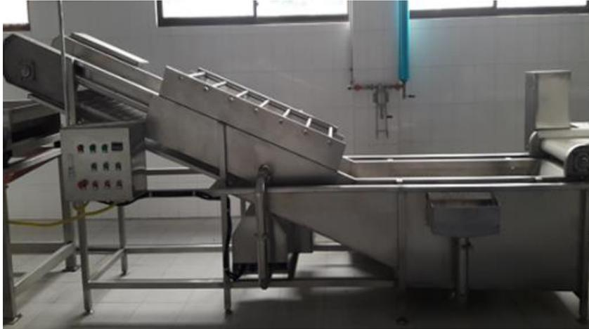
**FIGURA 8.- FUENTE: WEB-LAVADORA HIDRODINAMICA (SISTEMA DE BURBUJAS)**
