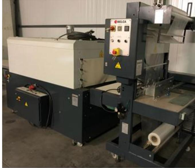
**FIGURA 43.- FUENTE: TUNEL DE EMPACADO FILM TERMOCONTRAIBLE**
