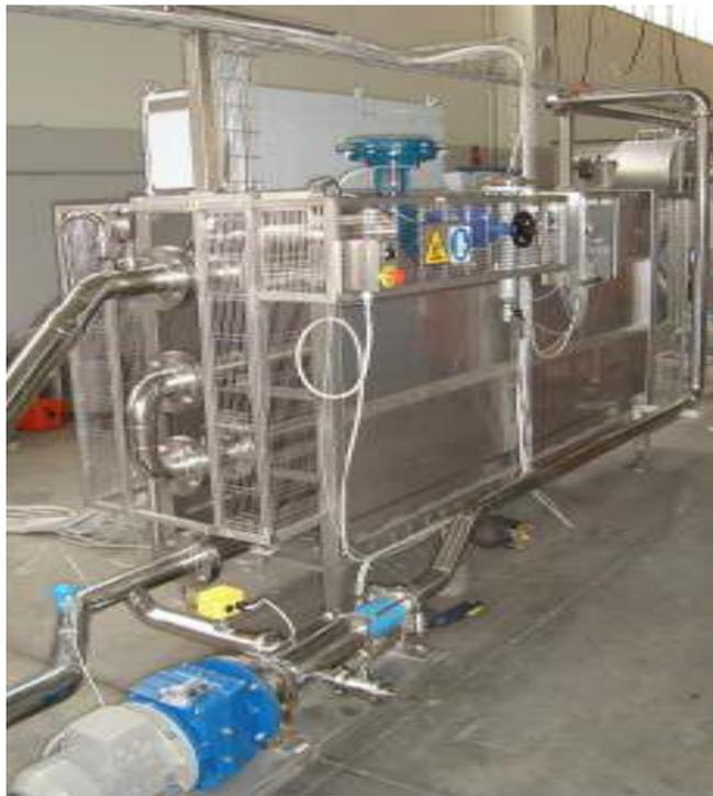
**FIGURA 24.- FUENTE: WEB-ESTABILIZADOR ENZIMATICO TUBULAR CON ENFRIAMIENTO**
