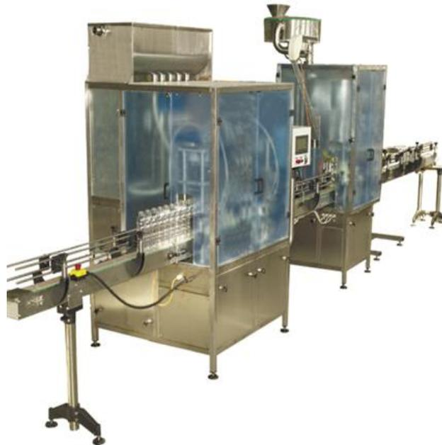
**FIGURA 42.- FUENTE: LINEA DE EMBOTELLADORA PET (LAVADORA, ENVASAADORA, TAPADORA, CODIFICACDORAY ETIQUETADORA).**
