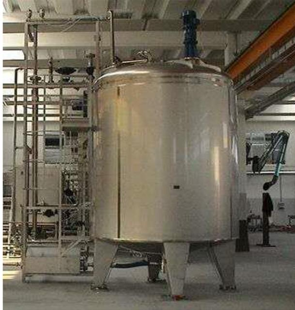
**FIGURA 39.- FUENTE: TANQUE PULMON ISOTERMICO PARA NECTAR**
